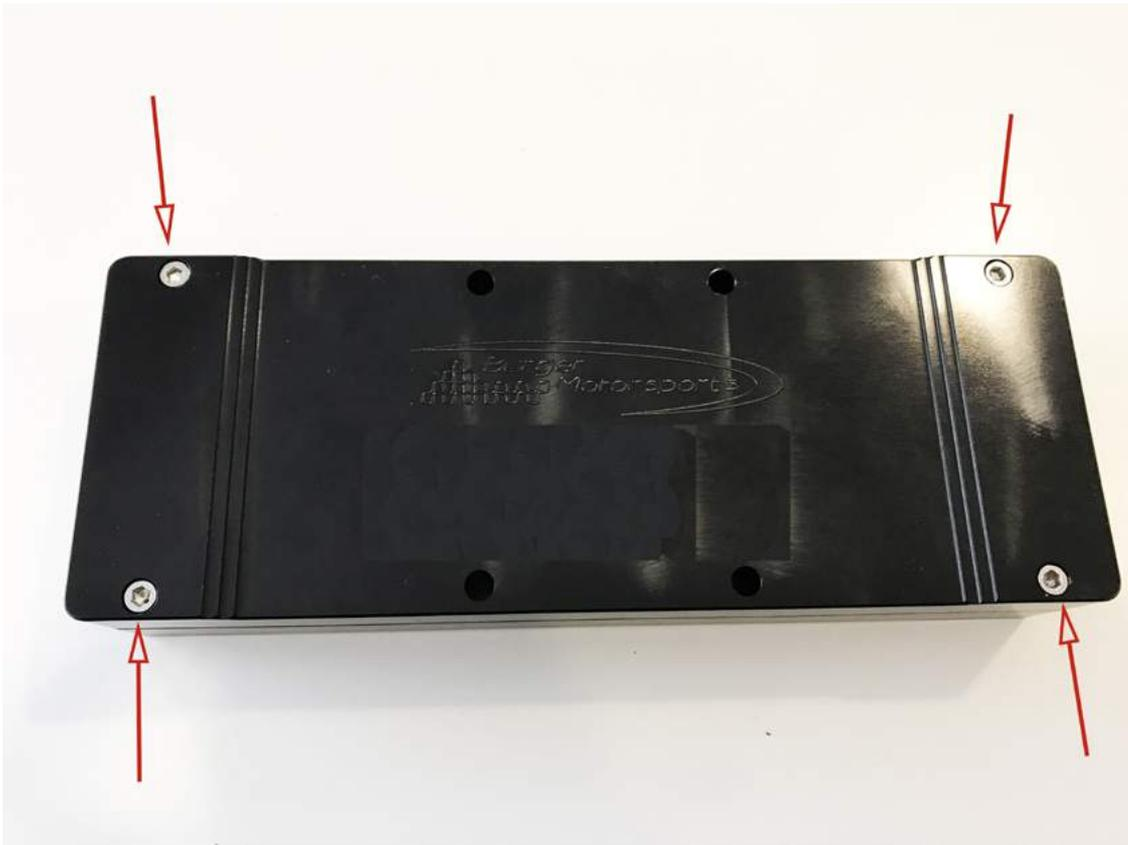
Entfernen Sie die vier Schrauben im JB4 Alu-Gehäuse (7/64 Bit) und öffnen es.
