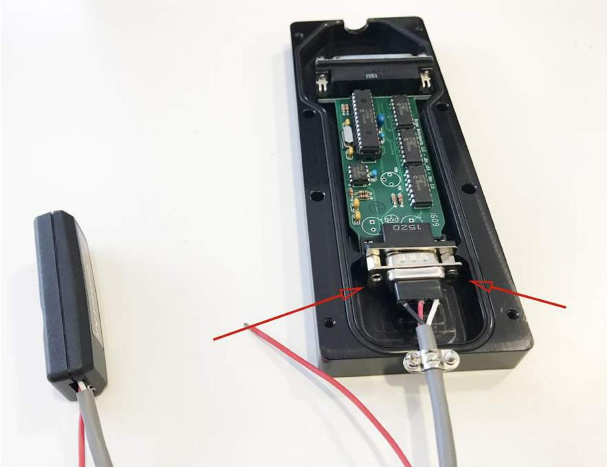
Verbinden Sie das Connect Kit mit dem JB4 Board. Achten Sie darauf, das JB4 Board nicht an der Platine zu berühren und vermeiden Sie elektrostatische Entladungen.
