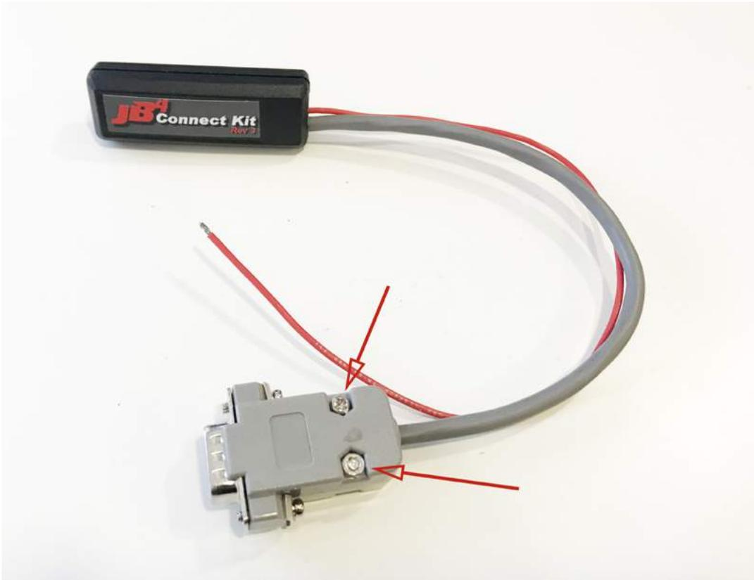
Entfernen Sie das graue Steckergehäuse am Bluetooth Connect Kit. Lösen Sie dazu die im Bild gekennzeichneten Schrauben.
