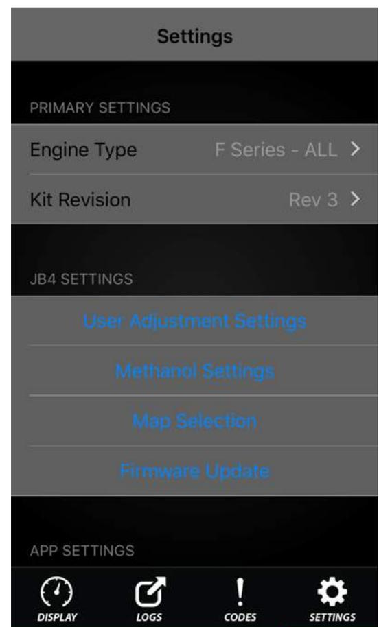
Wechseln Sie in den Bereich Settings und stellen Ihren Engine-Type (Motor) ein. Bei VAG Fahrzeugen ist noch N54 zu wählen.
