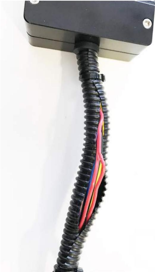
Ihr F-Serie JB4 wird mit 5V über den Ladedrucksensor versorgt. Daher muss das Connect Kit ebenfalls mit 5V betrieben werden. Nehmen Sie eines der beiden roten Kabel aus dem JB4 Kabelbaum.
