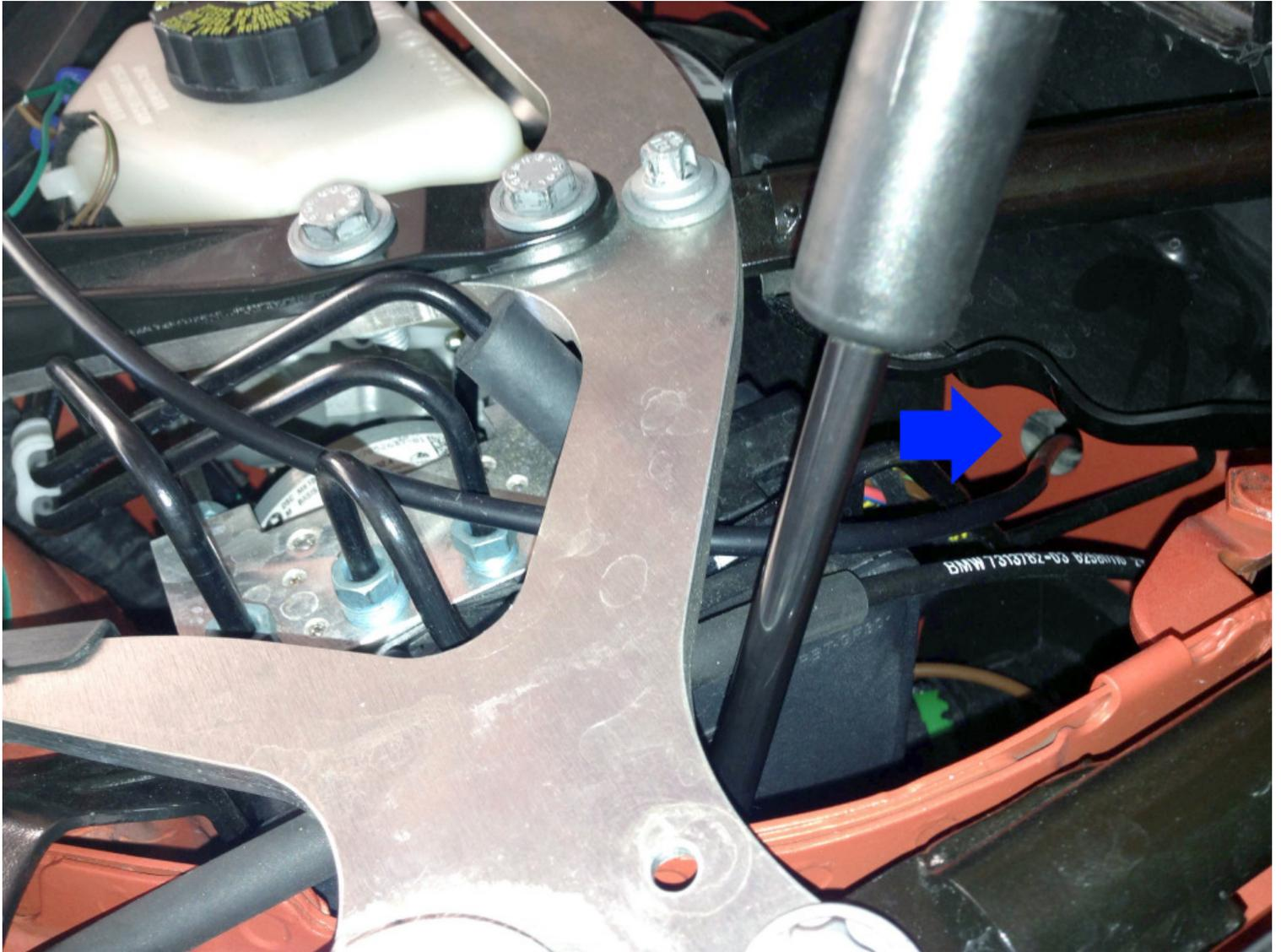
Hinweis: verfügt Ihr Fahrzeug über ein manuelles Getriebe verläuft die Kupplungsleitung durch die gleiche Öffnung. In diesem Fall drücken Sie den Gummistopfen beiseite und führen das Kabel ein.
