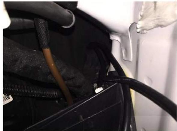
Entfernen Sie den Schaum und führen das OBD Kabel durch die gezeigte Öffnung. Das Kabel tritt hinter der Batterie in den Motorraum aus. Ohne die Batterie auszubauen kann diese Prozedur fummelig und umständlich erscheinen. Ein Kleiderbügel oder Faden am Stecker des OBD Kabels können bei der Führung hilfreich sein. Schließen Sie den OBD Stecker an.
